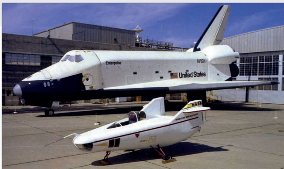
Дальний предшественник шаттла M2-F1 («М» означало «пилотируемый», «F» — «полет») — первый в мире летательный аппарат, построенный по схеме несущего корпуса — на фоне OV-101 Enterprise.
